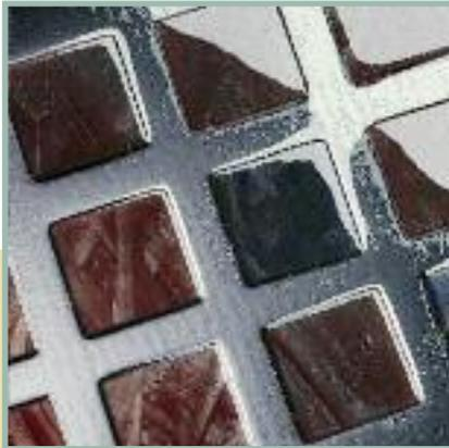
**SCHMELZGLAS** Farbige oder farblose Glaselemente werden auf die Glasscheibe geschmolzen. Durch den Schmelzvorgang erhält die Oberfläche eine feine Ornamentstruktur. Jedes Glas ist ein Unikat.
